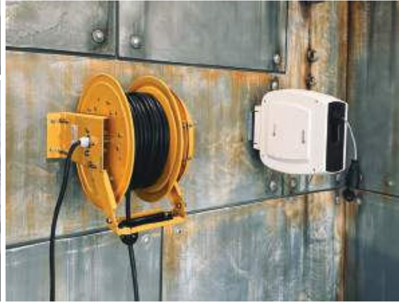
Tekstil Sektöründe Hareketli Makinalarda Kullanılan Enerji Aktarım Tamburu
